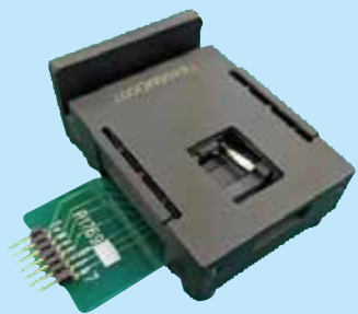
無線通信モジュール基板開発用ソケット
